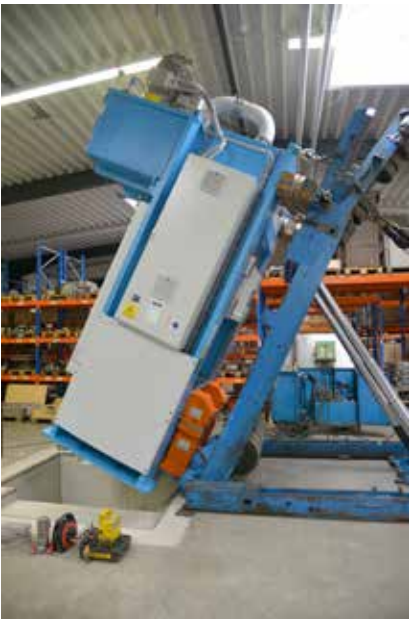
BU TZP-3: Eine Grube samt neuem Fundament musste im Vorfeld für die Tiefziepresse gebaut werden. Fotoquelle: Keinhorst GmbH
